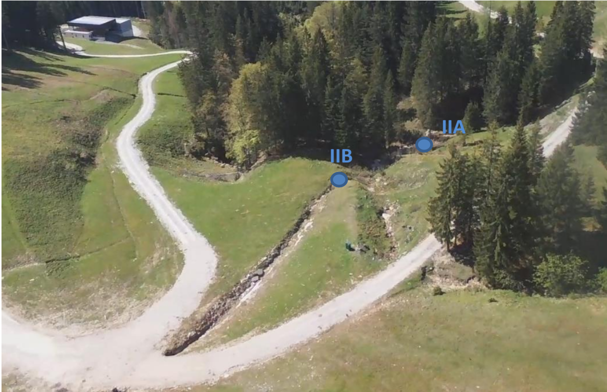
Abbildung 17: Übersicht Wasserfassung IIA und IIB (NMS GmbH 21.05.2016)
