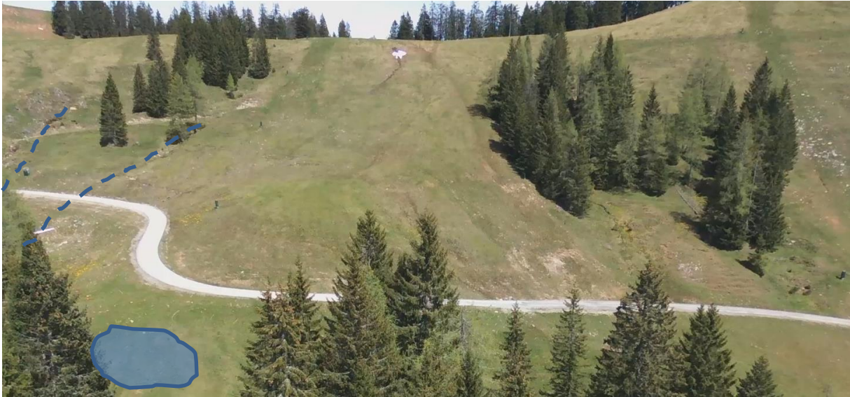
Abbildung 6: Fläche Pistenbau mit vorhandenen Gerinnen, geplanter Standort Retentionsbecken (NMS 21.05.2016)
