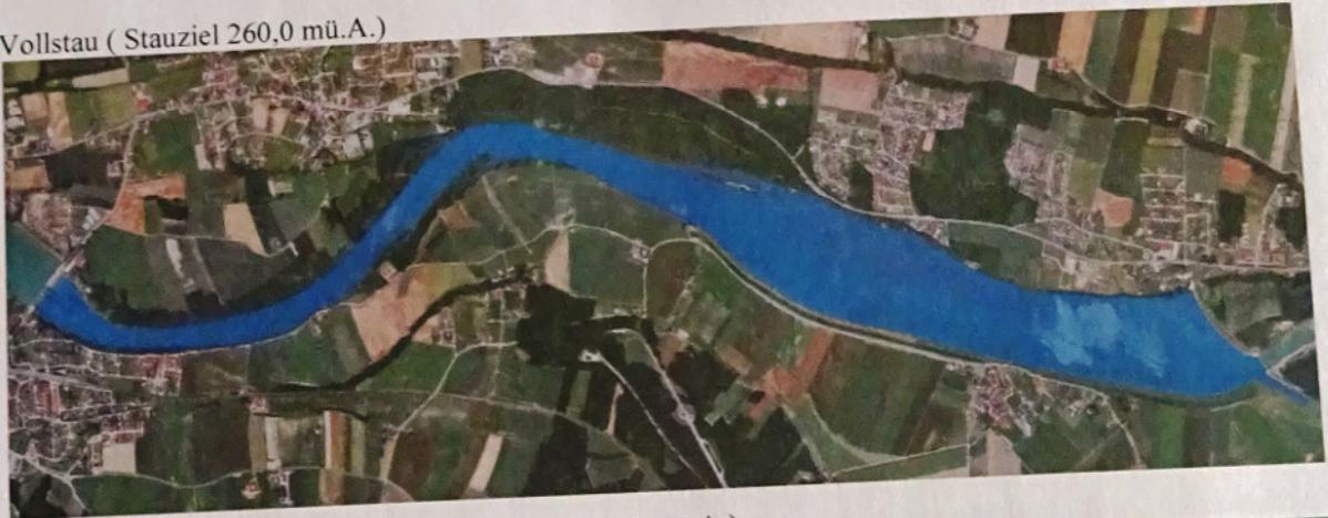
Genehmigter Schwellbetrieb 1m (Absenkziel (259,0 mü.A.)
