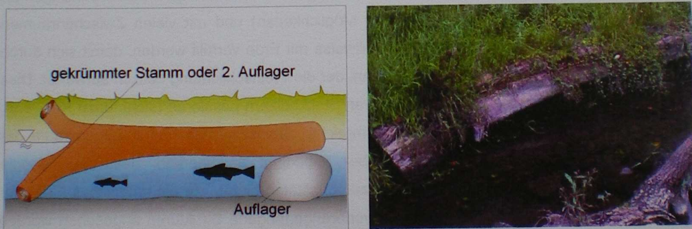
Abb. 15: Baumstämme und Bäume als Strukturelement am Ufer. Linke Abbildung: Systemskizze (verändert nach GEBLER 2005). Rechte Abbildung: ins Ufer eingebauter Baumstamm (Foto aus GEBLER 2005).
